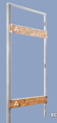
A : Les entretoises de passage protègent l'huisserie des déformations lors de la pose et sont retirées une fois la cloison entièrement réalisée.
