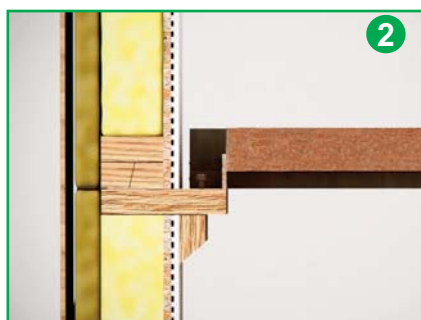
Mise en oeuvre du hourdis EBS
