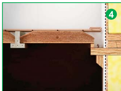
Pose des chaînages de rive à l'horizontal sur les poutrelles
